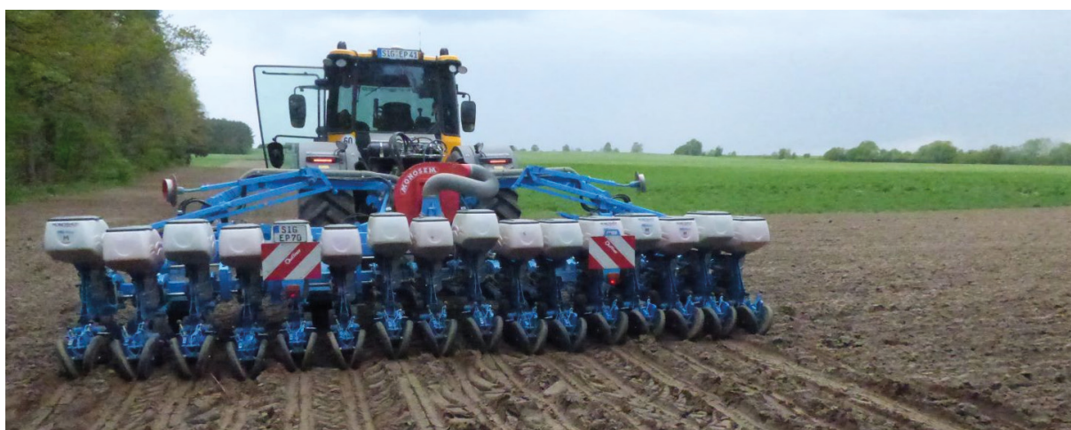
Silphieaussaat: Wurden bis vor wenigen Jahren noch fünf bis sechs Personen benötigt, um innerhalb von zwölf Stunden einen Hektar Silphie mithilfe von Jungpflanzen zu bestellen, kann dieselbe Fläche 2020 durch den Einsatz von neu entwickeltem, präpariertem Saatgut und speziell entwickelten Drillmaschinen in ca. 30 Minuten erledigt werden. Bei geeigneten Boden- und Niederschlagsverhältnissen kann in einem Arbeitsgang Mais zwischen die Silphiereihen gelegt werden. Foto: DVL BB.
