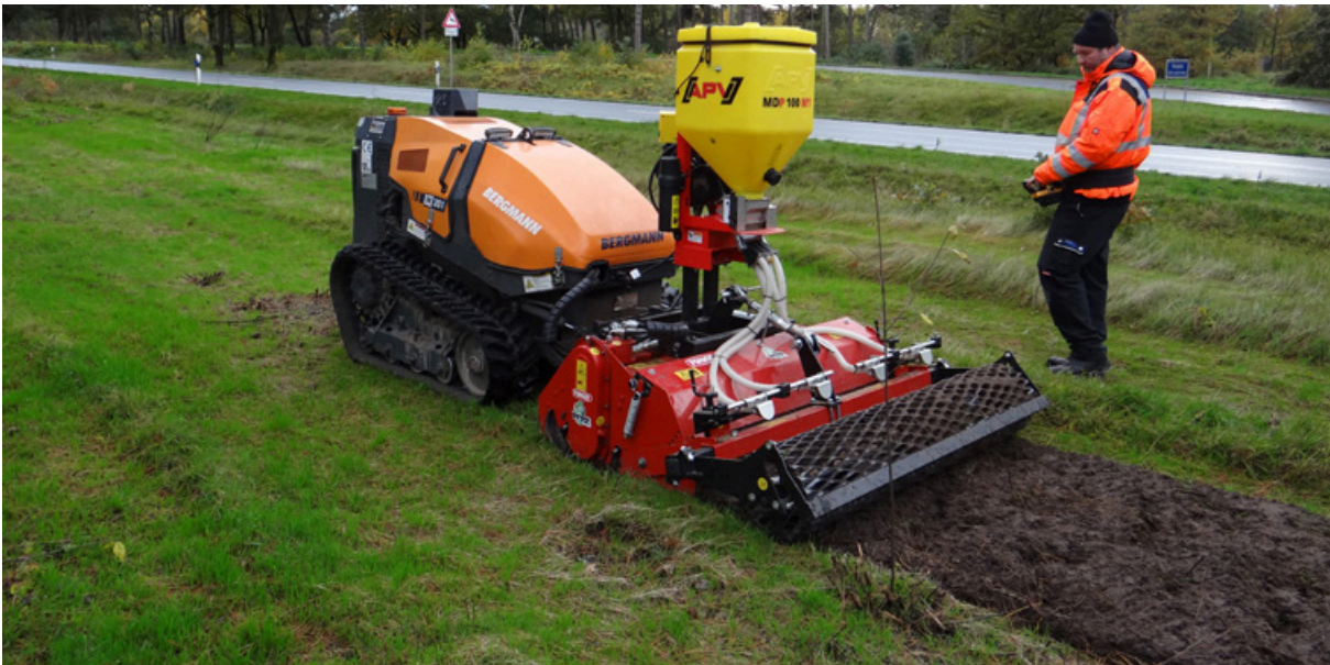
Abb. 3: Raupengeführte Umkehrfräse-Saat-Kombination. Mit dem Gerät können alle notwendigen Arbeiten (Fräsen, Säen, Walzen) auch in steileren Böschungslagen in einem Arbeitsgang durchgeführt werden. Foto: D. Finke
