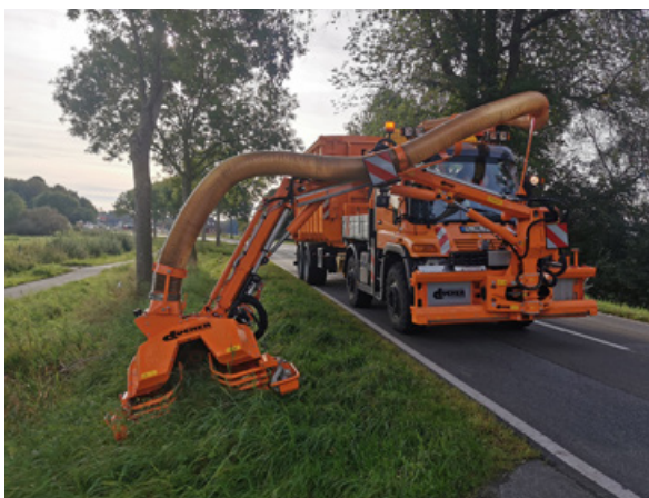
Abb. 2: Insektenfreundliches Balkenmähergerät im Frontanbau an einem Unimog. Foto: M. Clausen
